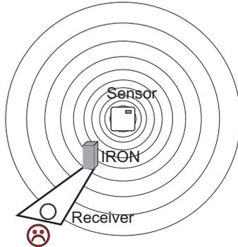
Zudem spielt der Winkel eine Rolle, mit dem das gesendete Signal auf die Wand trifft. Je nach Winkel verändert sich die effektive Wandstärke und somit die Dämpfung des Signals. Nach Möglichkeit sollten die Signale senkrecht durch das Mauerwerk laufen. Mauernischen sind zu vermeiden.
